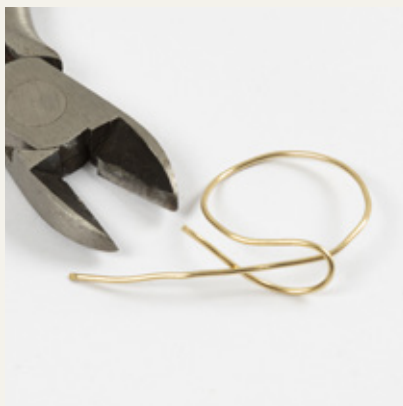
14 Taivuta metallilankaa kuvan osoittamalla tavalla, säädä se sormen ympäröymiseksi sopivaksi ja leikkaa sitten ylimääräinen metallilanka pois.
